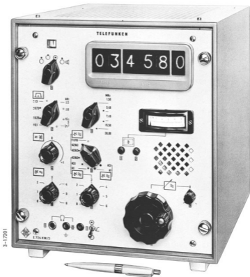
Kurzwellen-Empfänger E 724 KW/2 im Tischgehäuse HF Receiver E 724 KW/2 in Desk Cabinet
