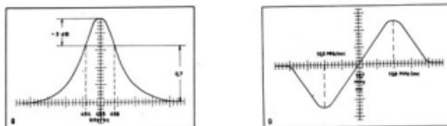
Die Messung ist am leichtesten durchzuführen, wenn der Meßsender über ein kleines C (2 - 8 pF) entweder direkt an die Basis des Mischtransistors oder an den ZF-Einspeisungspunkt angeklemmt wird.
