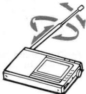
**KW:** Ziehen Sie die Teleskopantenne ganz heraus und stellen Sie sie senkrecht.
